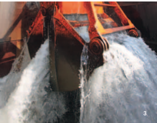
2-4 | Der Greifer hebt pro Arbeitsgang 7,5 Tonnen Material. 5 | Der Sand wird mittels «Schnecken» befördert.
