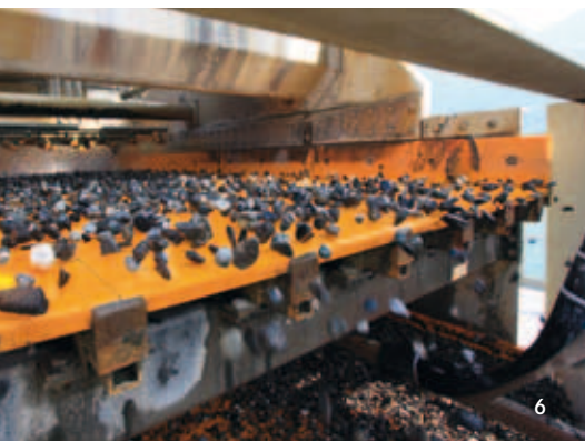
6 | Bereits auf dem Bagger wird das Material von Unrat befreit und sortiert. 7-8 | Förderbänder beladen die Nauen.
