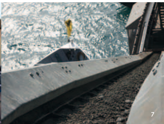
6 | Bereits auf dem Bagger wird das Material von Unrat befreit und sortiert. 7-8 | Förderbänder beladen die Nauen.
